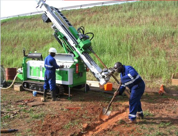
► Validation anomalies géophysiques et caractérisation des matériaux par réalisation de reconnaissances destructives géologiques et géotechniques (sondages destructifs ou carottés, essais in situ: pénétrométriques et de perméabilité, essais laboratoire sur échantillons)
