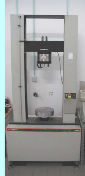
Traction directe : détermination de la classe de résistance
