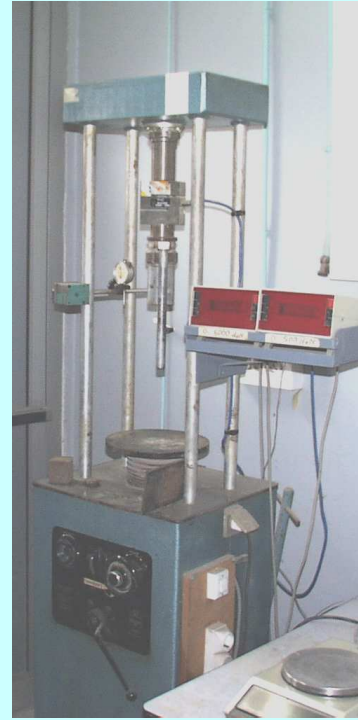
Mesure IPI : mesure de la stabilité immédiate
