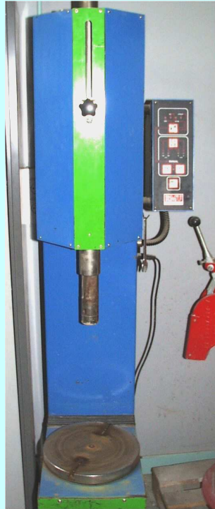
Essai Proctor : comportement au compactage
