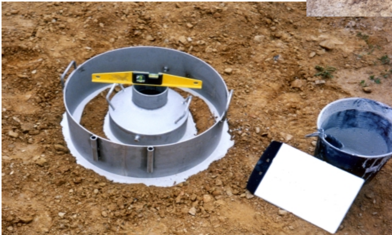
Perméamètre PANDA® II à double anneau ouvert (ANTEA)
